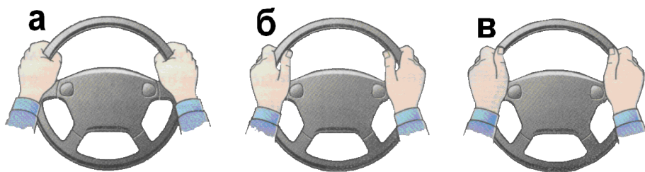
Рис. 4 Варианты захвата рулевого колеса: а) – закрытый хват; б) – неполный хват; в) – открытый хват
