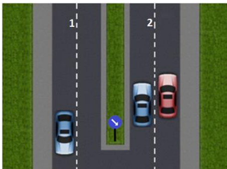
Рис.3. Две односторонние проезжие части тогда по каждой из проезжих частей организуют движение только в одном направлении.
