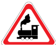
1.2 «Железнодорожный переезд без шлагбаума»
