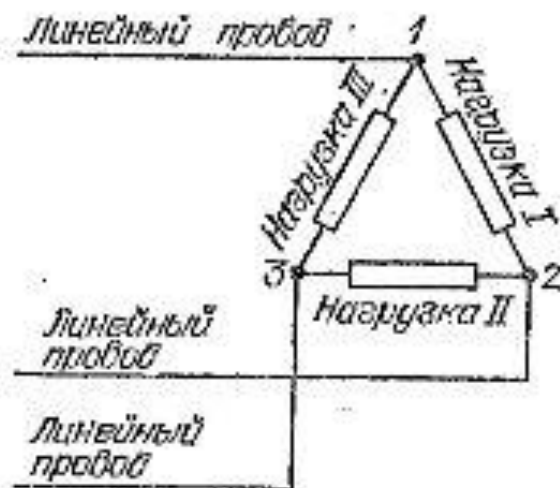
Рис. 7. Соединение нагрузок треугольником при трехпроводной системе проводки
