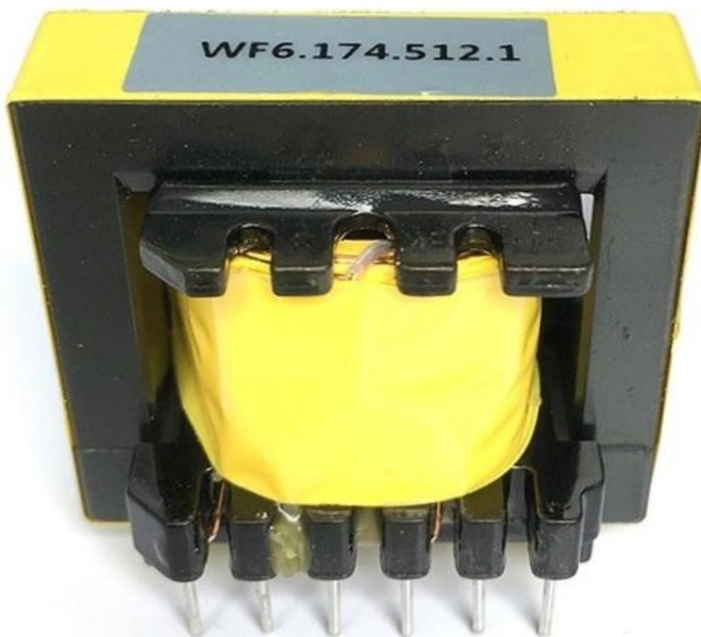
Данный трансформатор предназначен для преобразования тока (напряжения) импульсной формы. Короткие импульсы, обычно прямоугольные, подаваемые на его первичную обмотку, заставляют трансформатор работать практически в режиме переходных процессов.
