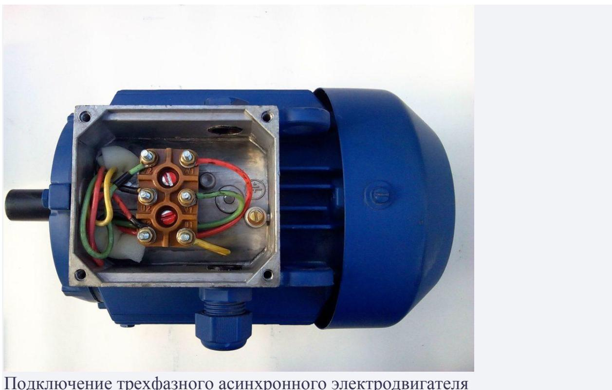
Подключение трехфазного асинхронного электродвигателя
