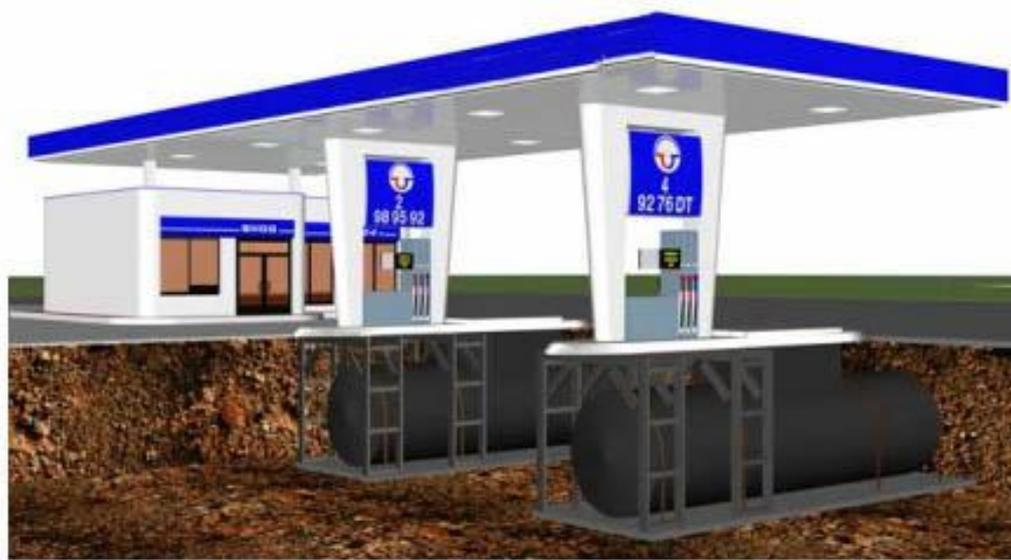
Рисунок 1. «Блочная АЗС»
