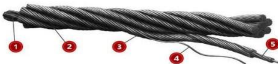
Стальной канат двойной свивки: 1 - сердечник; 2 - канат; 3 - прядь; 4 - проволока; 5 - внутренний слой каната
